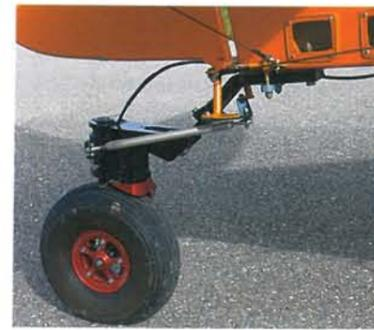
La fameuse roulette anti-cheval de bois de Beringer offre une maniabilité maximale au sol, tout en assurant un bon contrôle au décollage.
