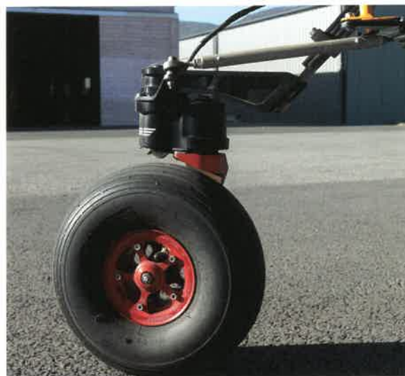
La roulette de queue anti-cheval de bois de Beringer. Le système est à double articulation avec un levier de verrouillage dans le cockpit.
