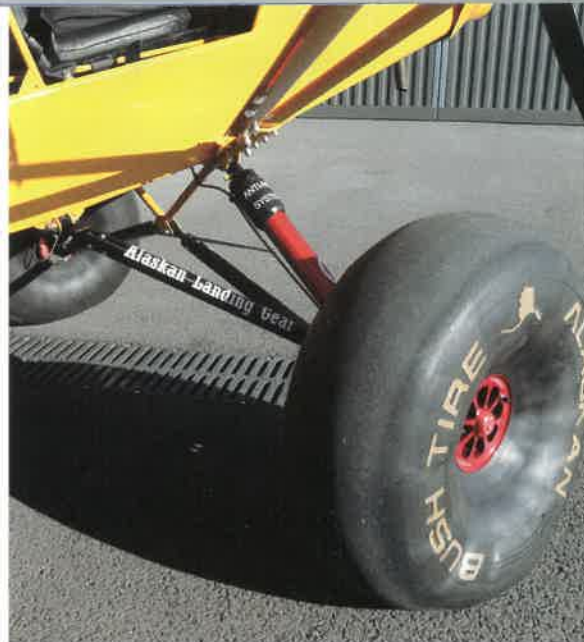
Le train ALG et son Anti Roll System sont, ici, associés aux pneus Bush Tire de 29 pouces. Ainsi équipé, le Savage peut quasiment se poser partout : labours, champs, lits de rivière, sable, terrains gras... L'ALG a été testé à 3.5 G.
