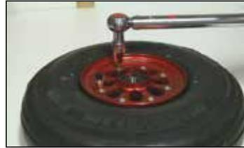
Serrer à 10N.m (+-1Nm) équivalent à 1m.kg (+- 0.1m.kg)
