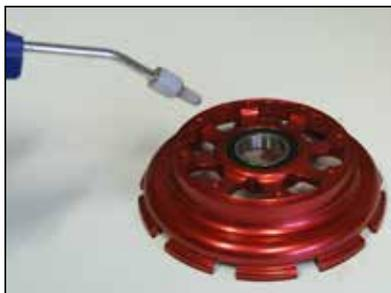
Nettoyer l'autre flasque à l'air comprimé ou bien avec un chiffon en vérifiant qu'il n'y a pas de saleté dans la gorge du joint.
