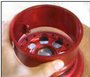
Positionner l'entretoise de la jante comme et appuyer avec la main. Vérifier que le tube et le flasque de jante sont en contact.
