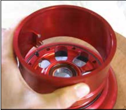
Positionner l'entretoise de la jante comme ci-dessus et appuyer avec la main. Vérifier que le tube et le flasque de jante sont en contact.
