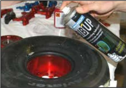
Pulvériser du lubrifiant entre le pneu et la jante afin de faciliter son décollement.
