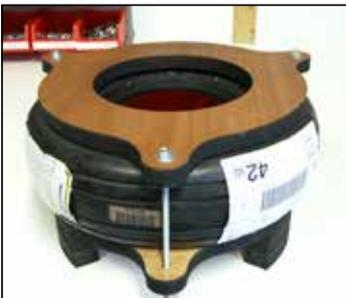
Positionner la deuxième partie de l'outillage spécial, insérer les trois vis. Comprimer le pneu jusqu'à ce que le flanc soit en-dessous du plan de surface de la jante. Nettoyer la jante sur son plan de joint.
