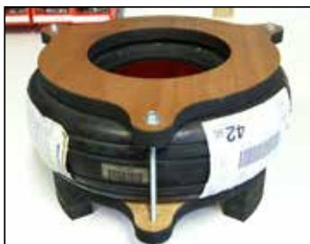
Positionner la deuxième partie de l'outillage spécial, insérer les trois vis. Comprimer le pneu jusqu'à ce que le flanc soit en-dessous du plan de surface de la jante. Nettoyer la jante sur son plan de joint.
