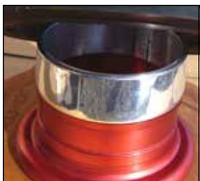
Placer l'outil en aluminium conique sur la jante (comme ci-dessus). Pulvériser abondamment du lubrifiant sur l'outil de montage conique puis positionner le pneu sur l'outil. Appuyer pour mettre le pneu en place.
