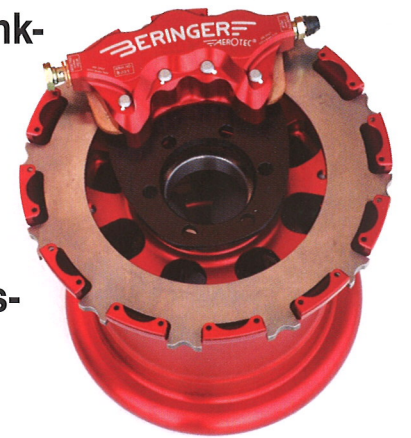
Zwei-Kolben-Bremssattel mit Sintermetallbeschlägen für die ULs.
