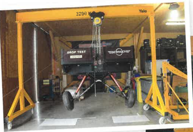
Drop Test: Viel mehr als den Landestoß bei maximalem Flugzeuggewicht muss das Fahrwerk im Prüfstand wiederholt aushalten
