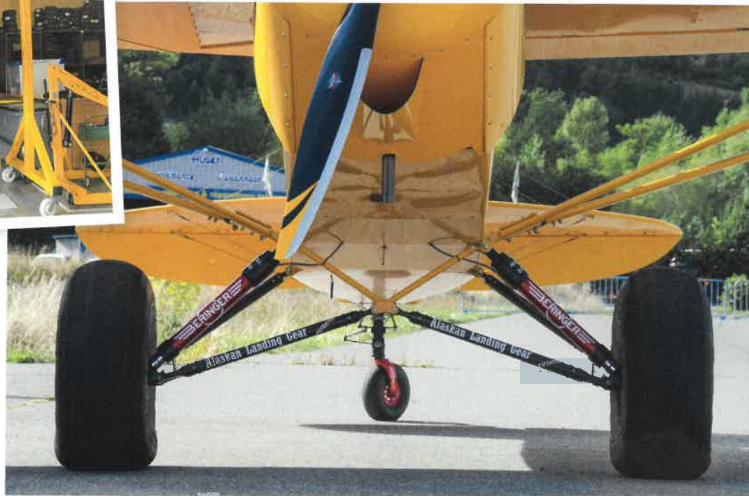
Drop Test: Viel mehr als den Landestoß bei maximalem Flugzeuggewicht muss das Fahrwerk im Prüfstand wiederholt aushalten
