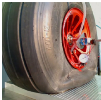
← ↑ Prensa hidráulica 44000Lbs para pruebas de carga última en las ruedas Prueba de rodadura de neumáticos de 29" →
