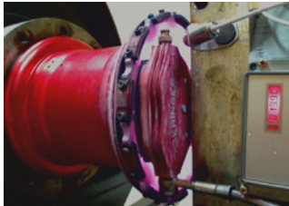
← Prueba de frenado en un banco dinámico para evaluar la capacidad de energía cinética del pinza de freno
