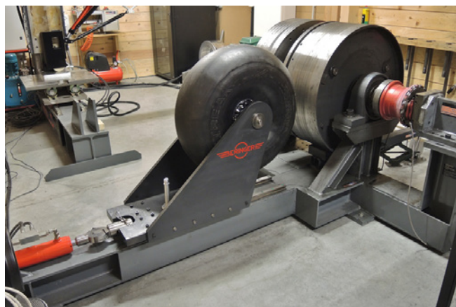
← ↑ Prensa hidráulica 44000Lbs para pruebas de carga última en las ruedas Prueba de rodadura de neumáticos de 29" →
