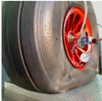
← ↑ Hydraulische Presse 44000lbs für Belastungstests auf Rädern und Reifen
