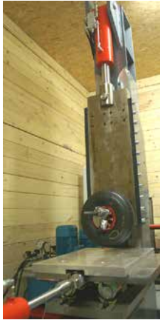
← ↑ Hydraulische Presse 44000lbs für Belastungstests auf Rädern und Reifen
