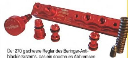
Der 270 g schwere Regler des Beringer-Antiblockiersystems, das ein spurtraues Abbremsen ermöglicht und zudem die Lebensdauer der Bremsbeläge und Reifen erhöht.
