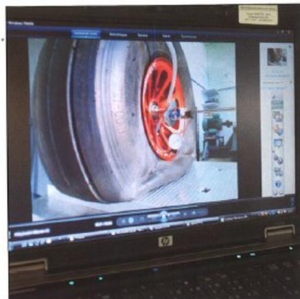
Hier werden Felge und Reifen eines Rades für den Pilatus PC-6 geprüft – besser: gequält. Denn per Knopfdruck kann die 20-Tonnen-Hydraulikpresse den Reifen schlagartig plazen lassen.
