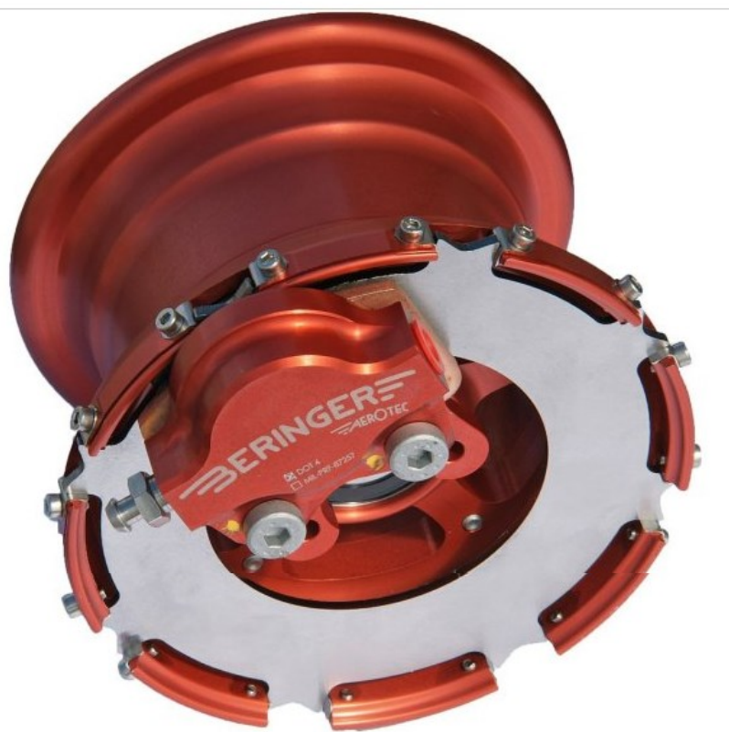
Nur 1,1 kg wiegt das neue 4-Zoll-Rad von Beringer komplett mit Scheibenbremse. Foto und Copyright: Beringer
